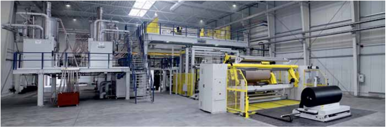
▲ Extrusionsbeschichtung ist ein Verfahren, bei dem eine Kunststoffschmelze mittels Extrusion über eine Breitschlitzdüse aufgebracht wird.
