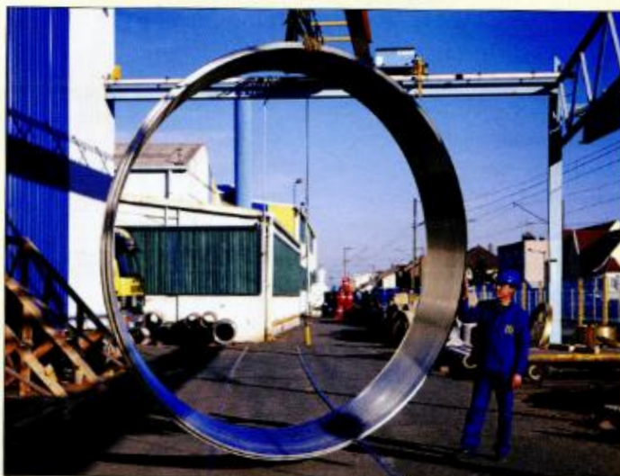
Der korrosionsbeständige Werkstoff Exium AM ist eine neue Legierung, die über ähnliche Dämpfungseigenschaften verfügt wie Nylon oder Polypropylen
